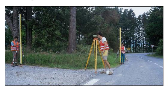
Mit einem neu entwickelten Präzisionsinstrument werden die Höhenunterschiede zwischen Höhenmarken, z.B. Metallbolzen nachgemessen, die schon vor Jahren oder Jahrzehnten genauer bestimmt wurden, um zwischenzeitliche Bewegungen der Erdoberfläche kontrollieren zu können. Die technischen Vorschriften legen strenge Maßstäbe an die Genauigkeit: jede Messung muss zweimal ausgeführt werden, erst dann kann z.B. der Höhenunterschied zwischen zwei Fixpunkten millimetergenau angegeben werden.
