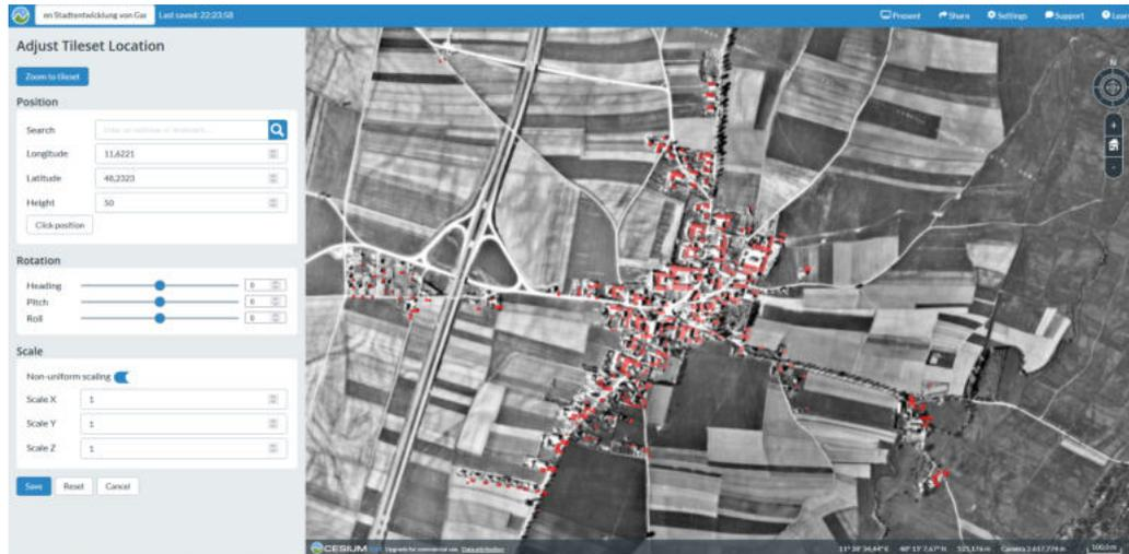
Abbildung 4.27: Fehler bei der Platzierung der 3D-Modelle in Cesium: Position der 3D-Modelle stimmt nicht mit den Luftbildkarten überein
