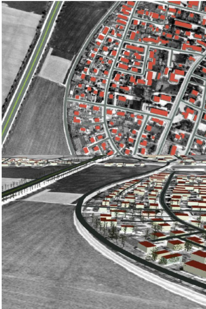
Abbildung 5.11: Visualisierungsfehler in Cesium: Obwohl die Straßen korrekt positioniert sind, liegen sie nicht vollständig auf dem Gelände
