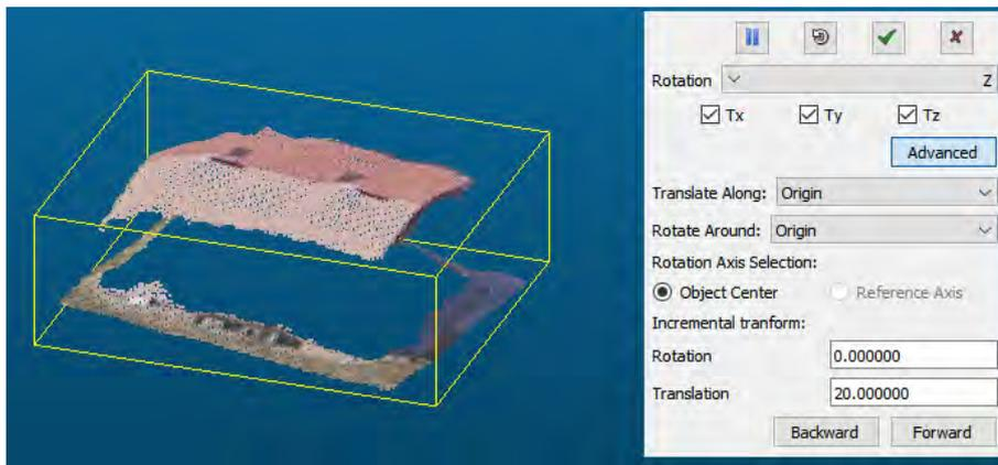
Abbildung 5.4: Verschiebung und Rotation von segmentierten Punkten
