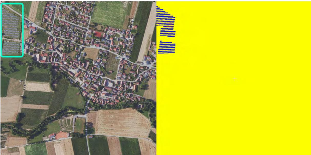
Abbildung 5.16: Detektion von Solarparkausreißern - Testgebiet 4 - RGB-Darstellung links, Klassifizierungs-Darstellung recht
