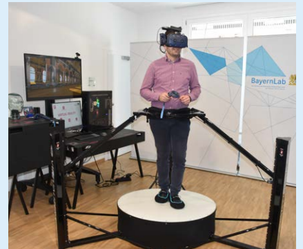
Der Virtualizer - ein „Virtual-Reality-Laufband“, auf dem man bei realen Bewegungen durch virtuelle Welten laufen kann © BVV
